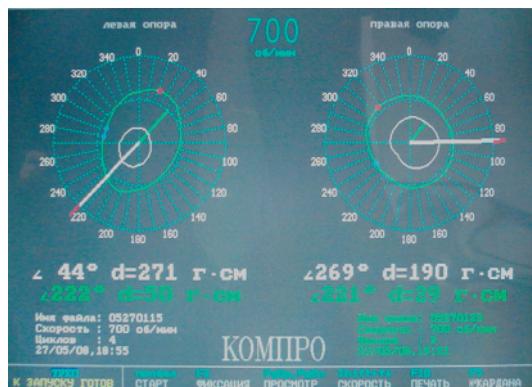
Рис. 3. Пример вывода графической информации о дисбалансе на экран монитора в балансировочных станках фирмы «КОМПРО»
