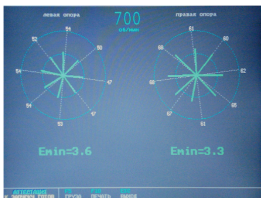
Рис. 5. Пример вывода информации результатов проведения метрологических измерений на балансировочных стендах фирмы «КОМПРО»
