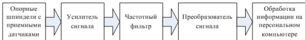
Рисунок 2 – Принципиальная схема измерительной аппаратуры балансировочных станков
