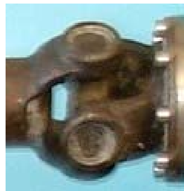
Рисунок 2 – Фиксация стаканчика подшипника карданного шарнира при помощи стопорных колец (а), болтов (б) или кернением (в): 1 – стаканчик подшипника; 2 – стопорное кольцо; 3 – уплотнение
